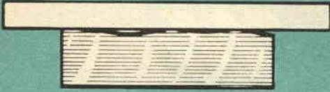
Per controllare la planarità si usano le righe a tragaruardare, osservando cioè la luce che filtra tra la superficie lavorata e lo spigolo della riga. La fig. 50a (in alto), mostra un piano mal lavorato, mentre la fig. 50b da un esempio di buona planarità.
