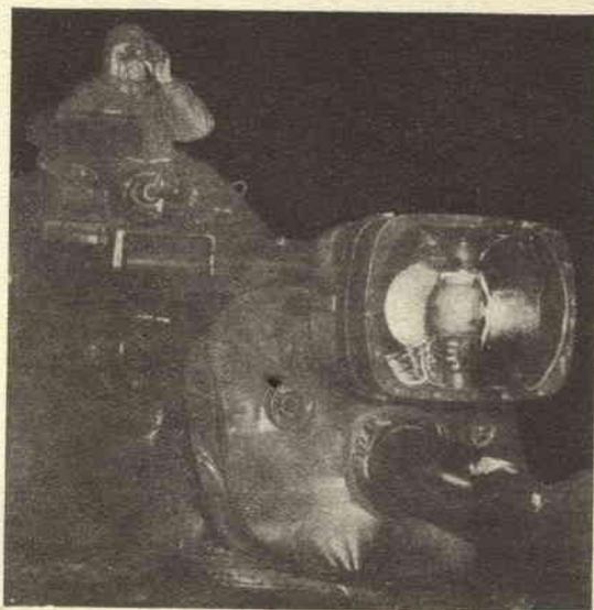
Il componente più caratteristico dell'equipaggiamento impiegato nella seconda guerra mondiale, ed ancora usato nell'esercito, è questo proiettore a raggi infrarossi montato su un carro M-60. Il comandante sta usando un binocolo convertitore d'immagini.
