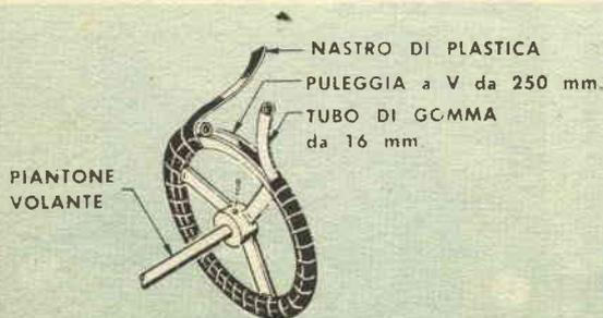
Ecco un modo semplicissimo per ottenere un volante pratico e funzionale; quel che occorre è una puleggia, un tubo di gomma ed un rivestimento fatto con un nastro adesivo di plastica: un sistema elementare per un risultato eccellente!
